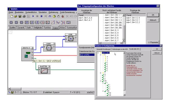
Dieser Treiber ermöglicht die Kommunikation zwischen dem blockorientierten Simulationssystem BORIS und einer Siemens SPS Simatic S7. Er ist
