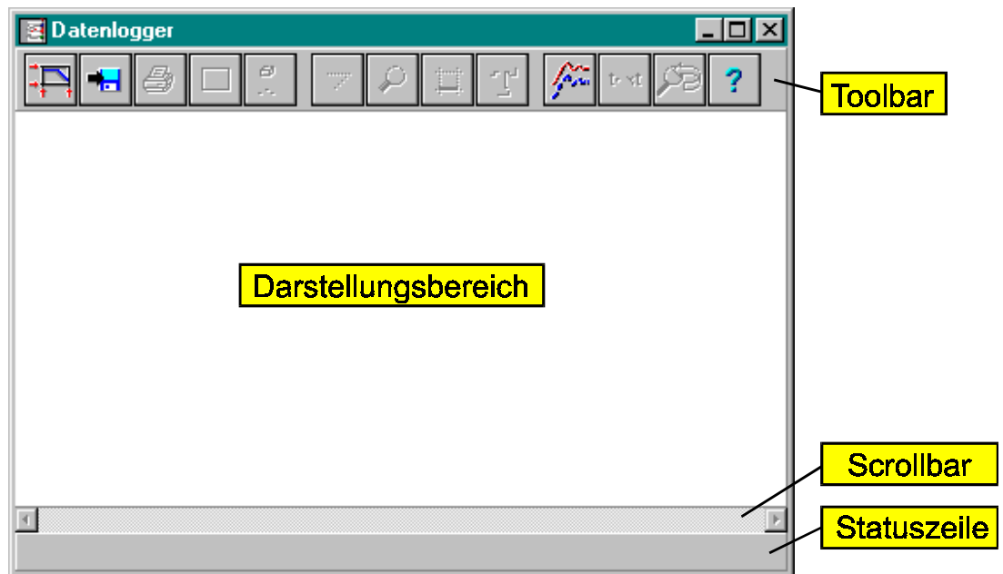
Anzeigefenster unmittelbar nach dem Einfügen des Datenlogger-Blocks
