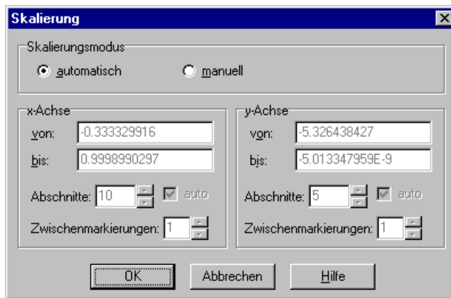
Dialog zum Skalieren der Achsen für Grafiken vom Typ XY, MXY, SIM, FWM oder OK. Bei manueller Skalierung kann die Anzahl der Achsenabschnitte automatisch oder manuell (dann mit freier Wahl der Zwischenmarkierungen) gewählt werden.
