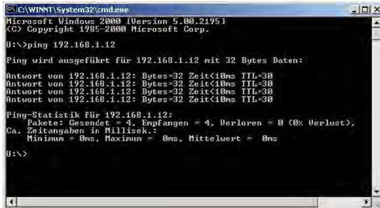
Abb. 5: Testen der Verbindung zum 750-841 Controller mit „Ping“
