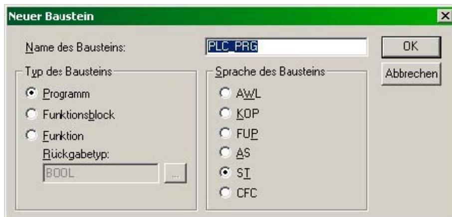
Abb. 10: WAGO-I/O-PRO CAA, Anlegen eines neuen Bausteins
