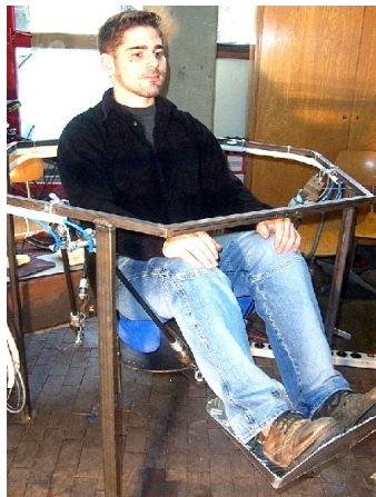
Abbildung 2: Sitz-Prototyp und resultierende Aktoranordnung in Hexapodstruktur
